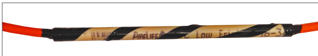
Bild 3 - Fastejpat VP-rör kring skarven.
